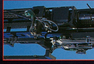
強い地盤も掘削できる 2速切替え回転モータ
